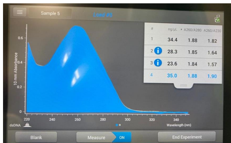
FIGURA 25: A imagem ilustra a interface do equipamento de espectrofotometria NanoDrop, da marca Thermo Fisher Scientific, onde pode ser observada a absorvância do DNA plasmidial analisado, utilizada para determinação da concentração e avaliação da pureza da amostra por meio de leitura espectrofotométrica.
